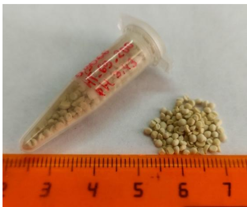
Рис. 1. Образец гранулированного фотокатализатора на основе политриазинимида
